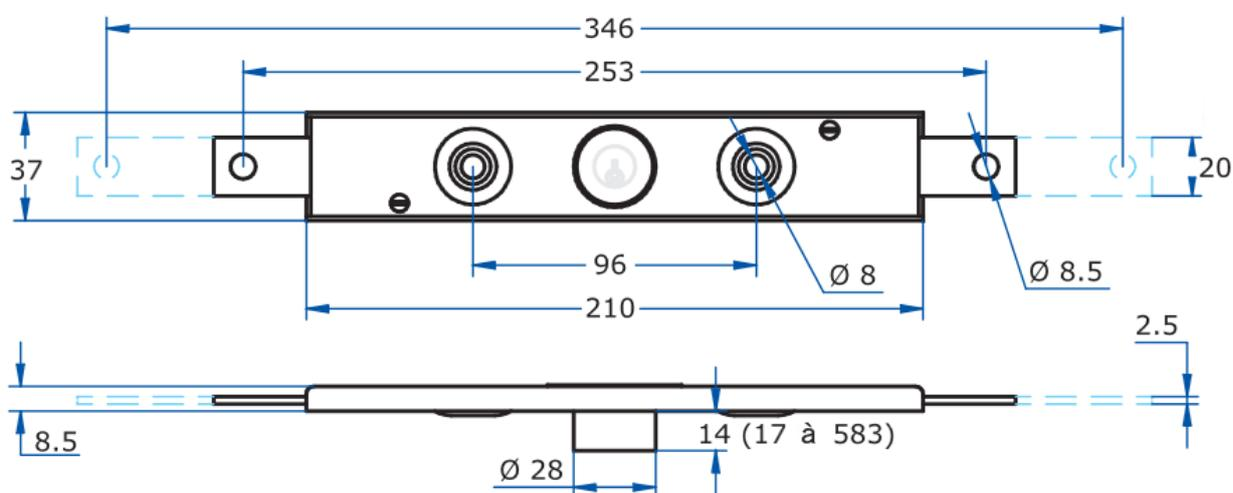
Corps acier galvanisé, cylindre laiton.
